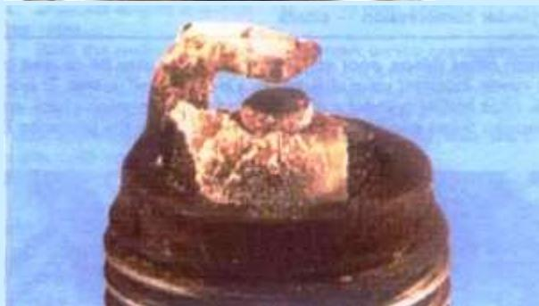
**Remèdes :** vérifier la carburation, l'allumage et la distribution. Remplacer par une bougie plus 'froide' (avec indice thermique plus faible)
