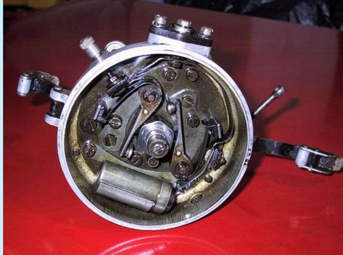
Sur les anciens moteurs à 6 cylindres et plus, parfois on installait 2 rupteurs pour diminuer le travail individuel des vis platinées.
