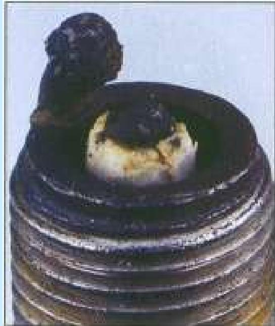
**Remèdes :** vérifier l'avance à l'allumage et si les bougies sont bien adaptées au moteur (indice thermique)
