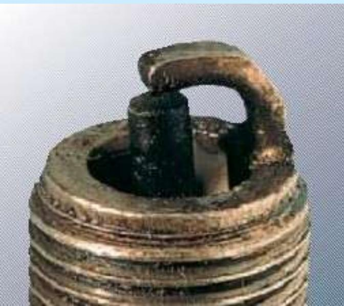
**Remèdes :** vérifier l'avance à l'allumage, la carburation (trop pauvre), le circuit de refroidissement
